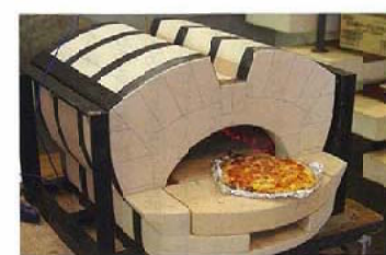
珪藻土炭火ピザオーブンの試作機
